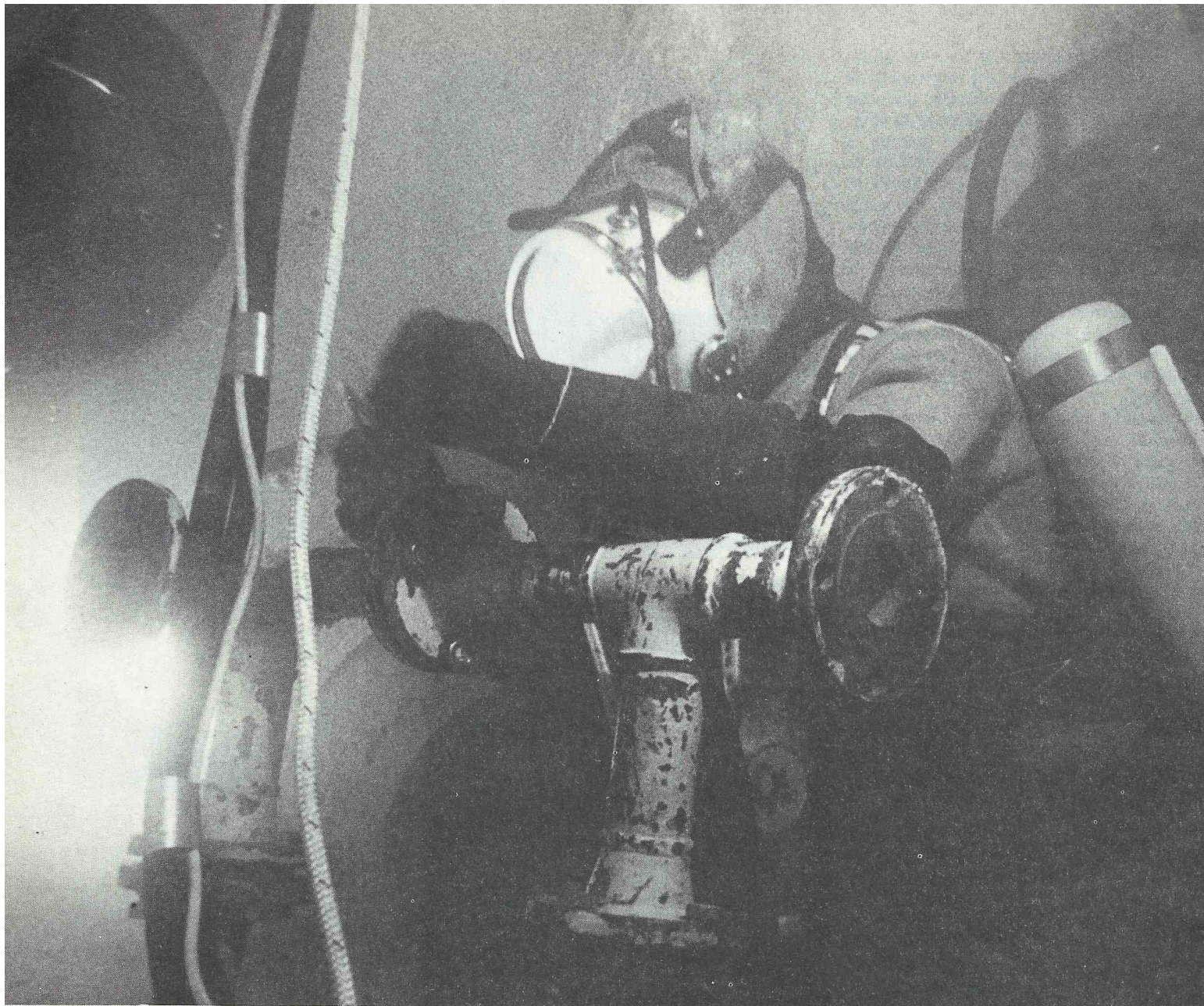
Dans la sphère humide de l'EMS 600, Vito Lentini reconstitue le puzzle. L'eau est à une pression équivalente à celle qui règne à la profondeur de 460 mètres !
