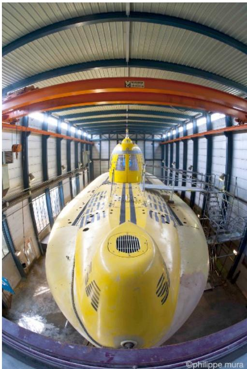
C'est le plus grand sous-marin civil du monde capable de déposer des plongeurs sur le fond jusqu'à 450m et d'intervenir jusqu'à 600m de profondeur par robot télé opéré (ROV)
