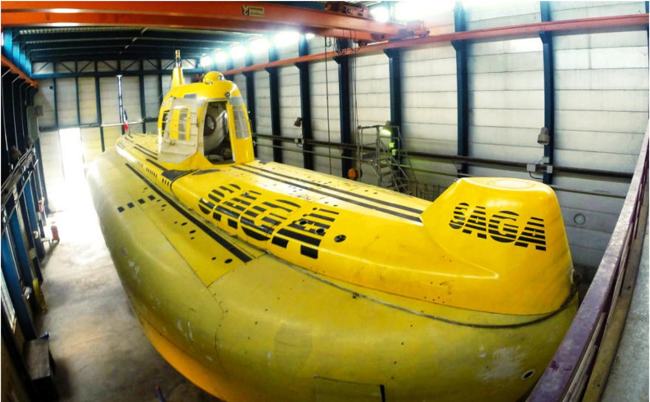
***SAGA acronyme de Sous-marin d'Assistance à Grande Autonomie. 300 tonnes, 30 mètres de long il repose sur son ber dans un hangar chargé d'histoire dans le village de l'Estaque de l'Estaque Plage pour être plus précis.***
